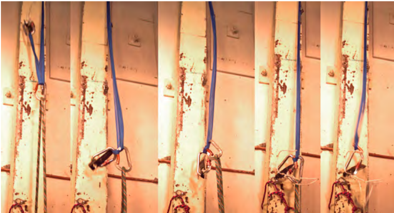
Figure 31: Simulation d'arrachement d'un piton lors d'une chute sur un couplage avec une sangle twistée.
