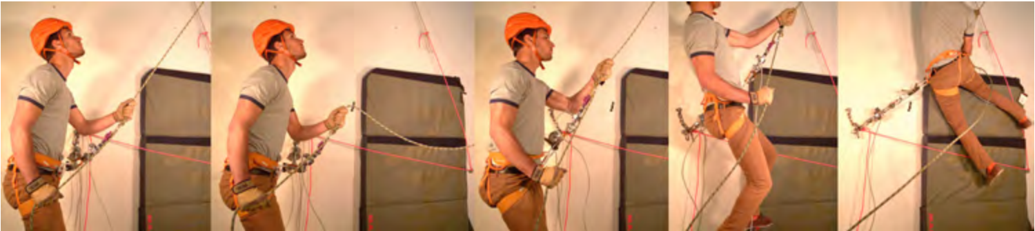
Figure 9: chute en facteur 0.5, demi cabestan sur le pontet : l'assureur est violemment projeté vers le mur
